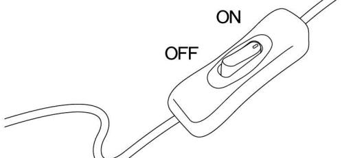
電源アダプターのコードに付いているスイッチで ON と OFF を切り替えることができます。
