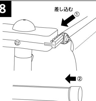
キャップをつけていない方から支柱上部と下部の窪みに上下横棒を中央までスライドして取り付けてください。
