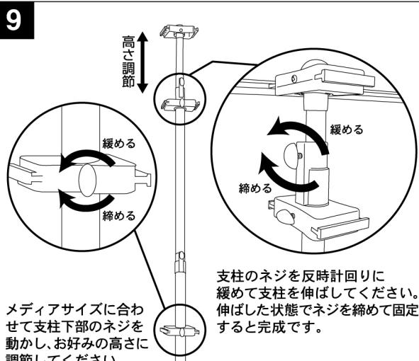
メディアサイズに合わせて支柱下部のネジを動かし、お好みの高さに調節してください。
