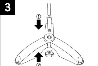
3点が地面に接しているかを確認し、連結器具に支柱を差し込んだ後、土台にはめ込み、下からネジを締めてください。
