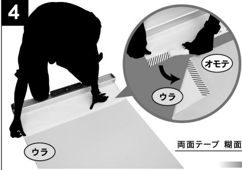
土台器具の両面テープを少しずつ剥がし、スクリーン裏面に両面テープ糊面が付くように貼付けます。
