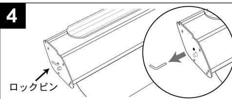
スクリーンを取り付けた後、土台側面にあるロック
