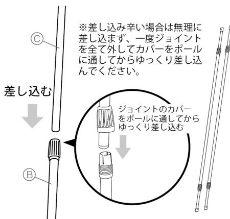
3 横棒延長ポールを差し込んだ横棒2本を透明ビニールシートの横幅に合わせて調節し、ジョイントをしっかりとしめて固定する。
