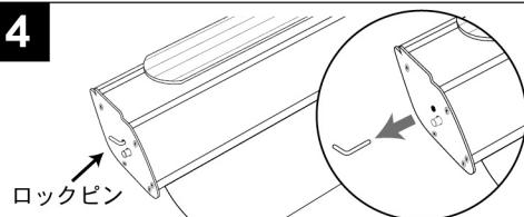
スクリーンを取り付けた後、土台側面にあるロック
